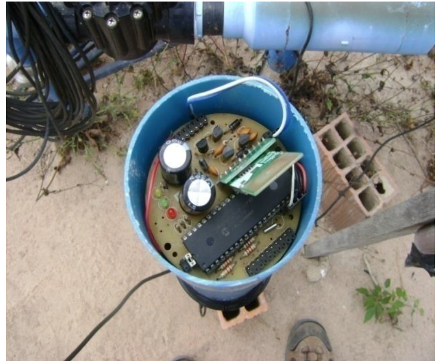
Figura 16 – Vista superior da placa base de acionamento das válvulas
