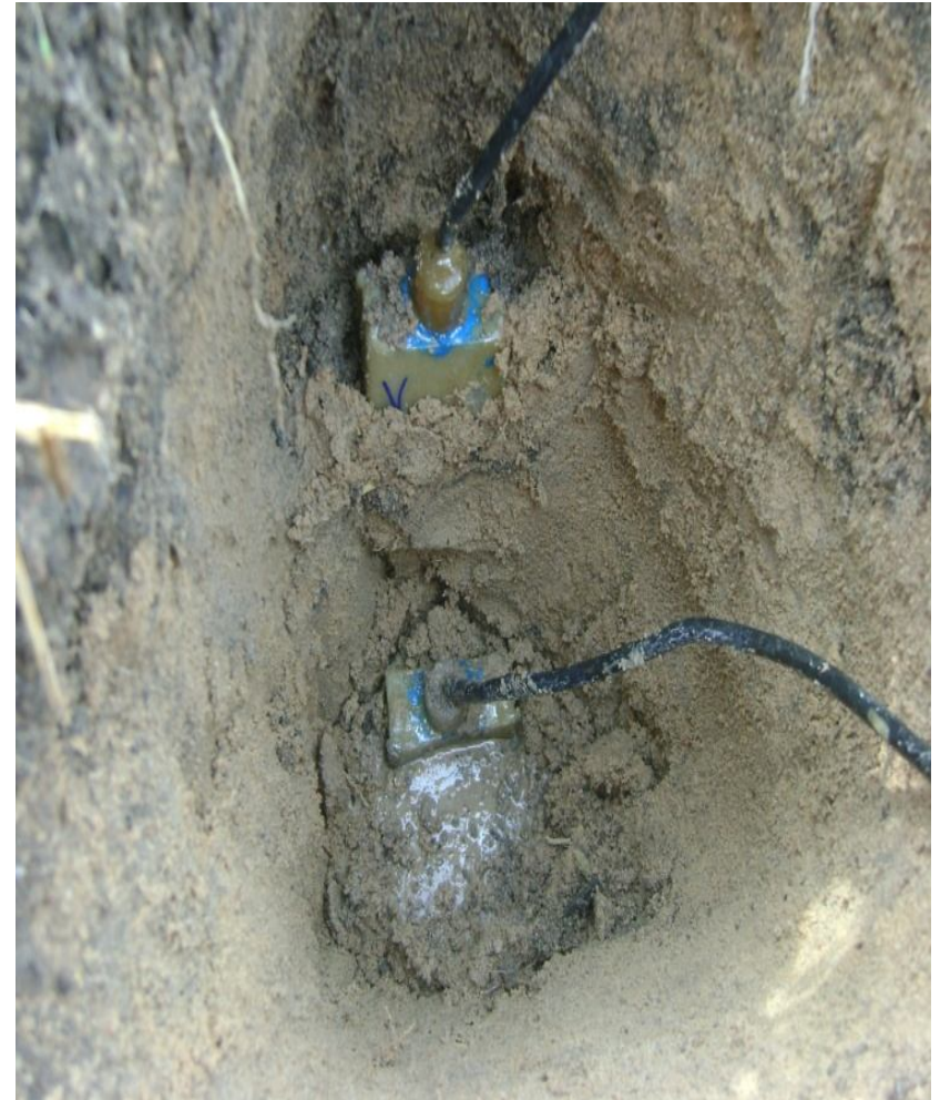
Figura 6 – Sensores instalados no solo a duas profundidades.
