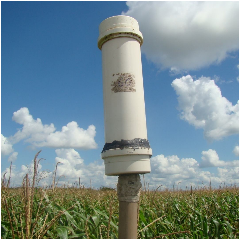
Figura 19 – Módulos multihops instalados acima da plantação de milho.
