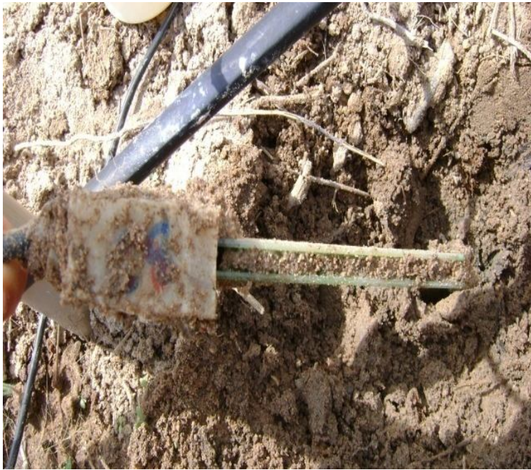
Figura 4 – Sensor retirado do solo.
