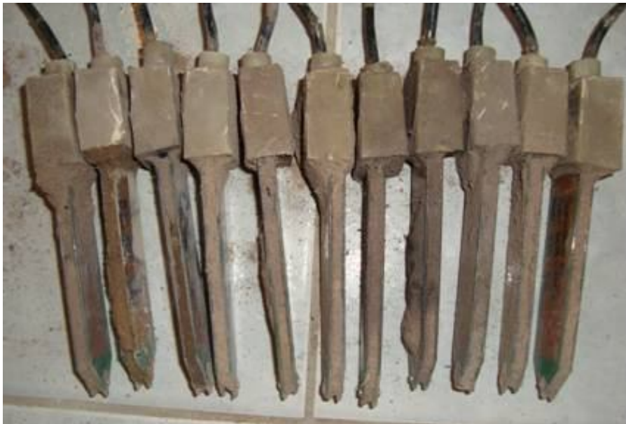
Figura 5 – Sensores preenchidos com solo.
