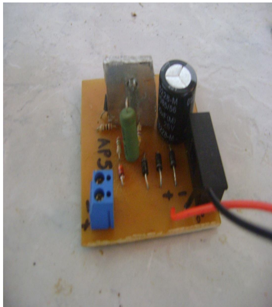
Figura 14 - Circuito para regular a passagem de tensão do painel solar para a bateria.
