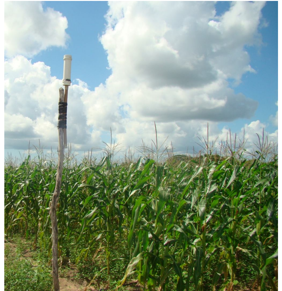
Figura 19 – Módulos multihops instalados acima da plantação de milho.
