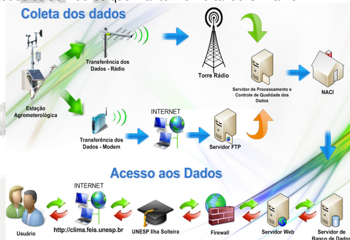
Figura 2. Esquema de coleta, armazenamento e disponibilização das variáveis climáticas
