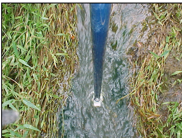
Figura 18. Utilização do molinete - medição da velocidade do fluxo da corrente.
