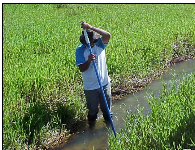
Figura 18. Utilização do molinete - medição da velocidade do fluxo da corrente.
