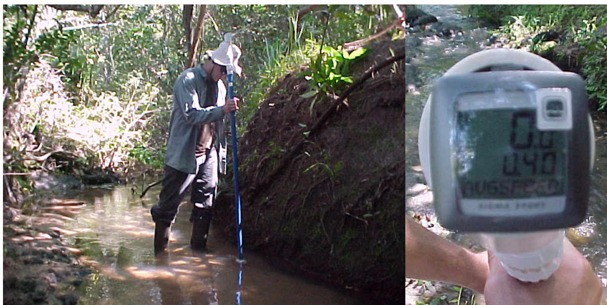
Figura 13. Medição da velocidade do fluxo por molinete hidrométrico (à esquerda) e detalhe da medida da velocidade (à direita).
