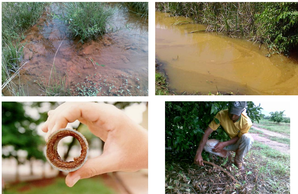
FIGURA 3 - Manancial sem conservação de solo e das nascentes, com elevada concentração de ferro na água, ferro depositado nas paredes da tubulação, levando à maior perda de carga por atrito e pressão no sistema e entupimento de emissores e limpeza de linha lateral como procedimento de manutenção do sistema.
