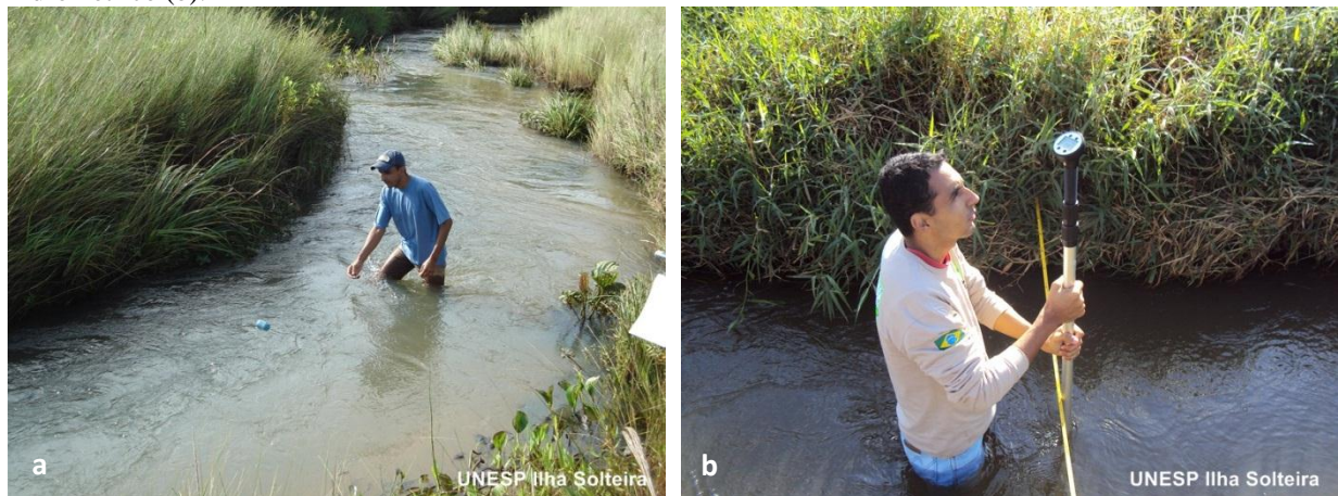
Figura 15- Medição da altura da seção molhada e a espera do flutuador (a) e medição pelo molinete hidrométrico (b).
