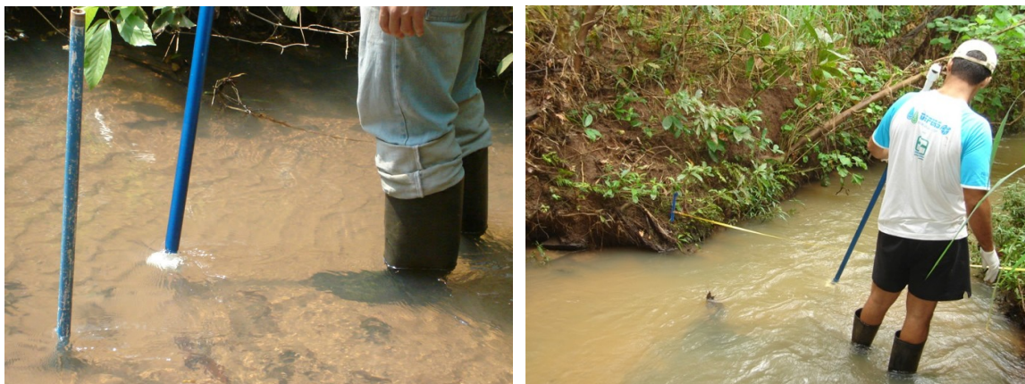
Figura 14. Medição de vazão utilizando o molinete hidrométrico, da marca Global Water, modelo Flow Probe FP101-FP201.
