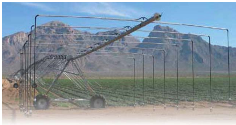
Construída principalmente de canaleta e tubos de alumínio leve, o boom system da Senninger fornece um sistema resistente a corrosão.
