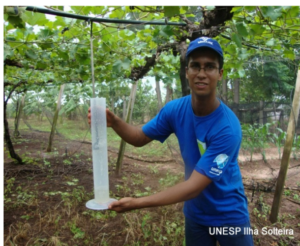
Figura 7. Membro da equipe coletando água para posterior avaliação da irrigação em um sistema de microaspersão invertida em uva.
