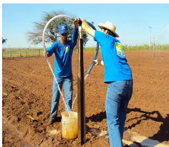
Figura 8. Membros da equipe coletando água para determinar a vazão do aspersor em um sistema de aspersão convencional em milho.
