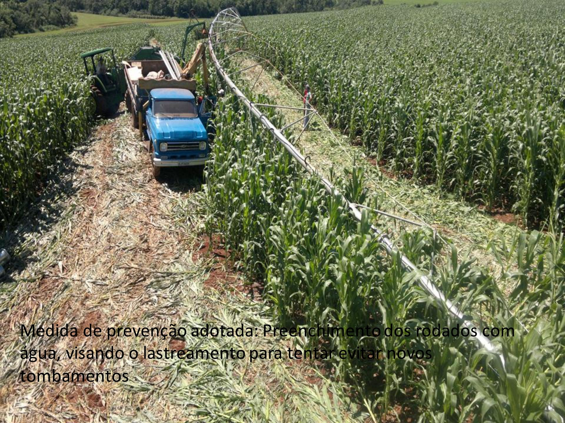
Medida de prevenção adotada: Preenchimento dos rodados com água, visando o lastreamento para tentar evitar novos tombamentos
