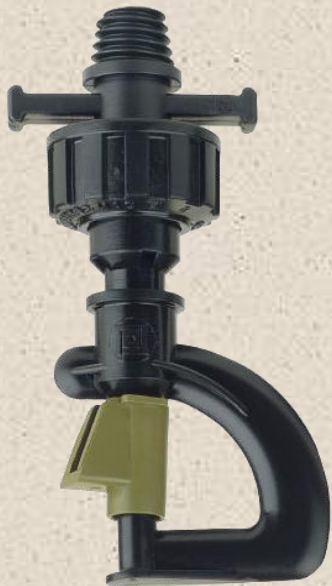
Modular Asa Giratória Invertida Bocal Verde (104 l/h) LPD Baixa Pressão Base 3/8"
