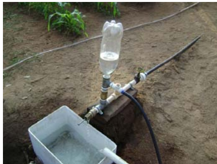
Figura 1. Ilustração do esquema de montagem do carneiro hidráulico.
