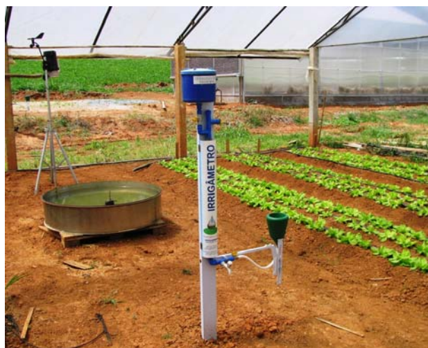
Figura 1. Irrigâmetro, Tanque Classe A e estação meteorológica automática instalados dentro da casa de vegetação.
