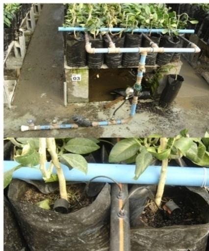
Figura 1- Sistema de fertirrigação com microtubos instalado na bancada experimental
