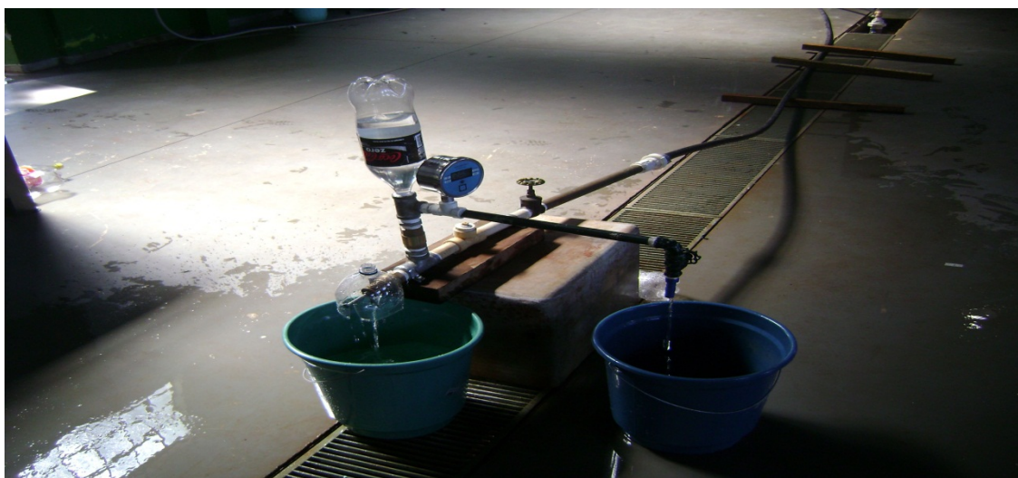
Figura 1. Carneiro hidráulico construído com garrafa PET.
