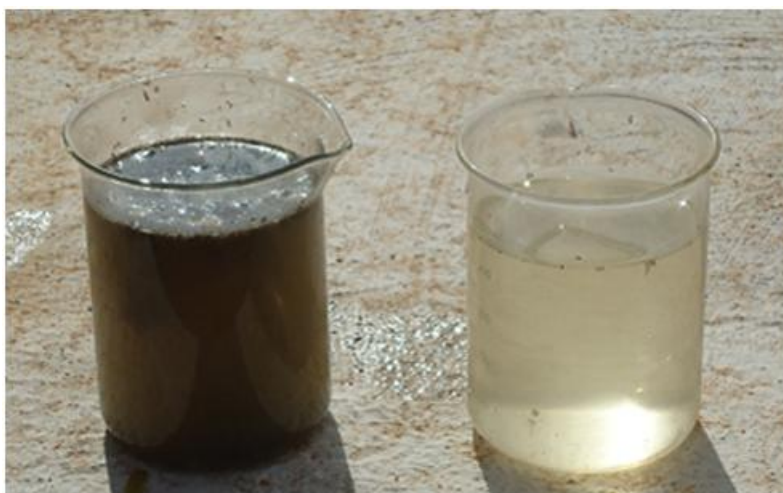
Figura 1. Indicador visual da qualidade do tratamento obtido na mini-estação. Esgoto coletado na entrada do sistema (a) e esgoto coletado na saída do sistema (b).
