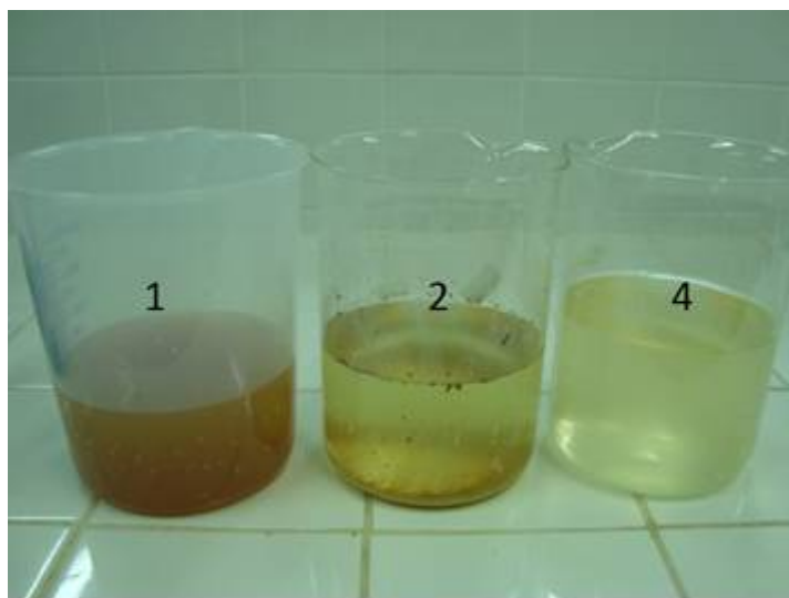
Figura 1 - Ilustração do resultado do tratamento da água em distintas etapas da miniestação: ponto 1 (água sem tratamento), ponto 2 (água após coagulação/floculação/sedimentação) e ponto 4 (água após exposição solar na placa).
