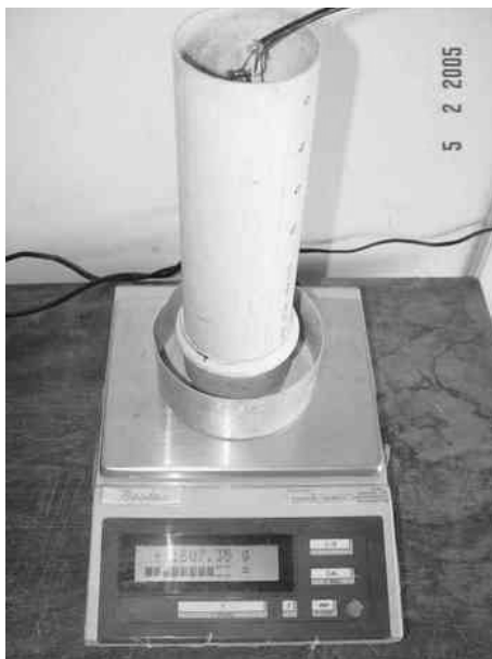
Figura – 1: Sensor instalado em tubo de PVC preenchido com substrato de casca de coco.
