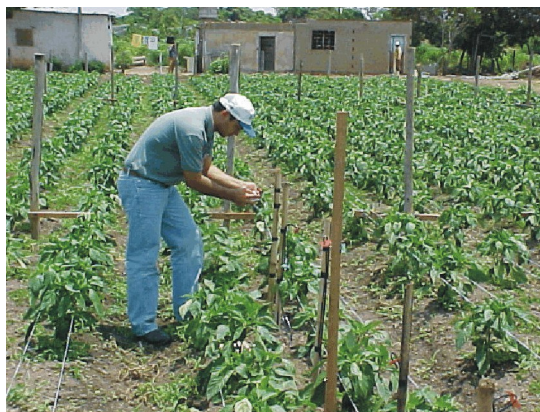
Figura 1- Estação de controle de irrigação com sensores Irrigas instalados em duas profundidades.
